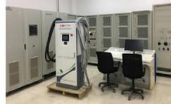
合肥质检实验室平台120KW 充电桩测试平台
